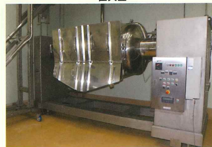
ジャケット付ニーダー釜
